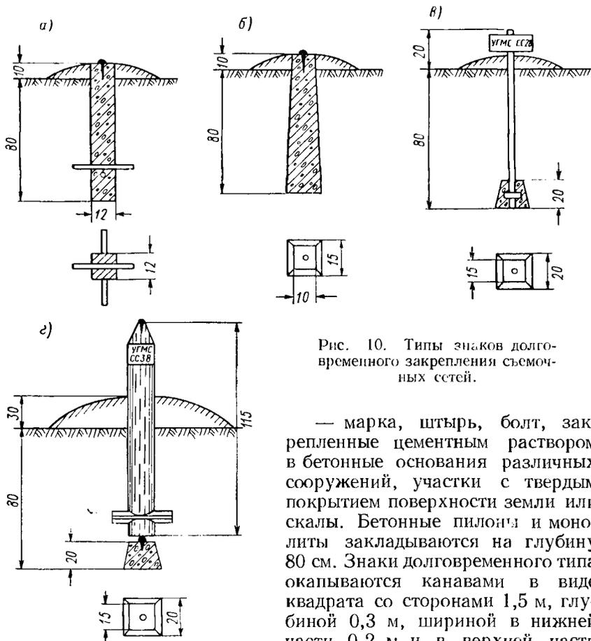
Рис. 10. Типы знаков долговременного закрепления съемочного обоснования.
