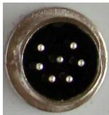
— коммуникационный разъем для подключения центра сбора данных и преобразователя гидростатического давления ДГС. Для удобства подключения по RS-485 может устанавливаться еще один разъем параллельно основному:
