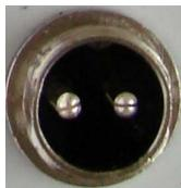
— напряжение 12 вольт соединяется с разъемом XPS.
